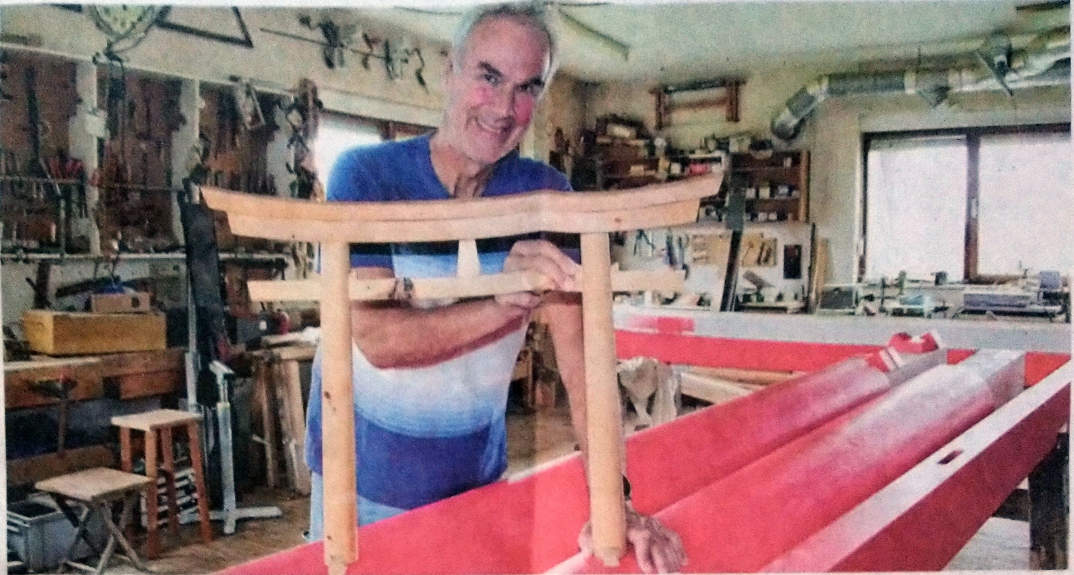
Klein wie groß: Jeder Torii, den Harald Dill in der Hoheimer Werkstatt baut, wird nach alter Tradition ohne Schrauben und Nägel gefertigt. Das große rote Tor wird bald genau die gleichen Proportionen haben wie das naturbelassene kleine. Foto: Diana Fuchs
